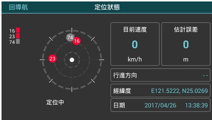
點選地圖頁右上角指北針進入此頁，左方顯示目前透過GPS取得的衛星訊號強度、編號和天空方位；右方則顯示目前行車速度、定位誤差範圍、行進方向、經緯度座標以及GPS時間。
