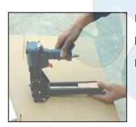
INSERT 2 STICKS OF APPROPRIATE STAPLES INTO THE MAGAZINE (030) FROM BACK. LET THE STICKS SLIDE FORWARD TO THE FRONT OF THE MAGAZINE (036)
