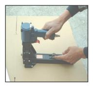
PULL PUSHER (036) BACK TO UPRIGHT POSITION AND GENTLY LET THE PUSHER (036) SLIDE FORWARD AGAINST THE STAPLES. DO NOT LET THE PUSHER (036) SLIDE FORWARD AND STRIKE THE STAPLES AT HIGH SPEED FOR THIS MAY DEFROM THE STAPLES OR DAMAGE THE TOOL.
