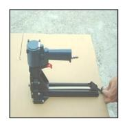
PULL PUSHER (036) BACK AND ROTATE TO LOCKED POSITION.
