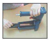
PULL PUSHER (032) BACK TO UPRIGHT POSITION AND GENTLY LET THE PUSHER (032) SLIDE FORWARD AGAINST THE STAPLES. DO NOT LET THE PUSHER (032) SLIDE FORWARD AND STRIKE THE STAPLES AT HIGH SPEED FOR THIS MAY DEFORM THE STAPLES OR DAMAGE THE TOOL.
