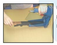
INSERT 2 STICKS OF APPROPRIATE STAPLES INTO THE MAGAZINE (029) FROM BACK . LET THE STICKS SLIDE FORWARD TO THE FRONT OF THE MAGAZINE (029)
