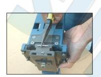
INSERT LONG NOSE PLIERS OR SCREW DRIVER TO CLEAR JAM. PULL BACK LEVER (043).
