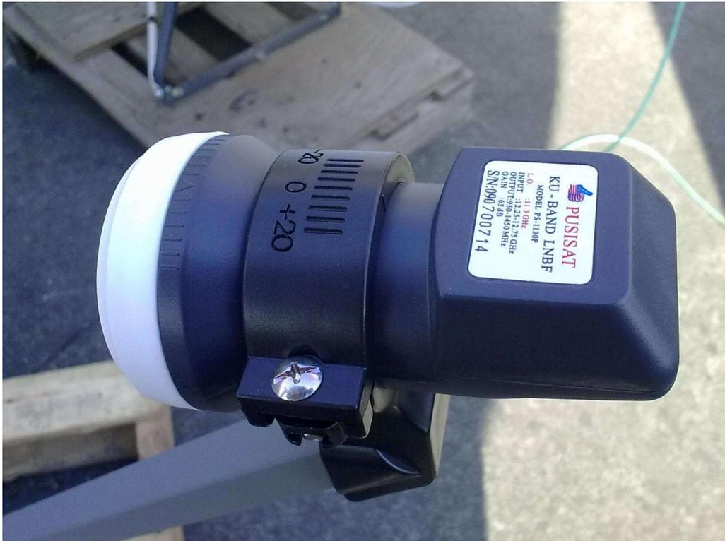
附圖二 高低本地振盪 9750MHz 及 10600MHz Universal 雙極性 LNB。
