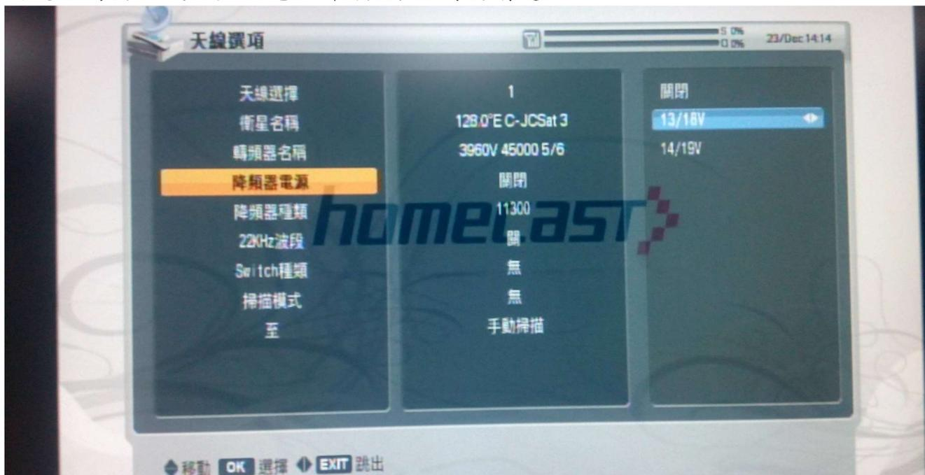
天線選項選擇降頻器種類設定正確的 LNB 本地震盪頻率。
