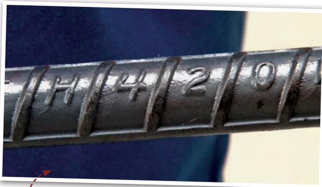
國產鋼筋軋記，包括國碼，以註明產地、生產履歷完整；鋼筋上面標示的420為鋼筋強度。
